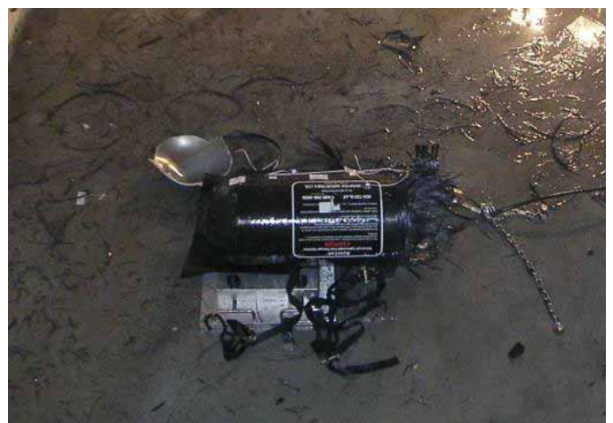
図 3 破裂試験後の高圧ガス容器の様子
